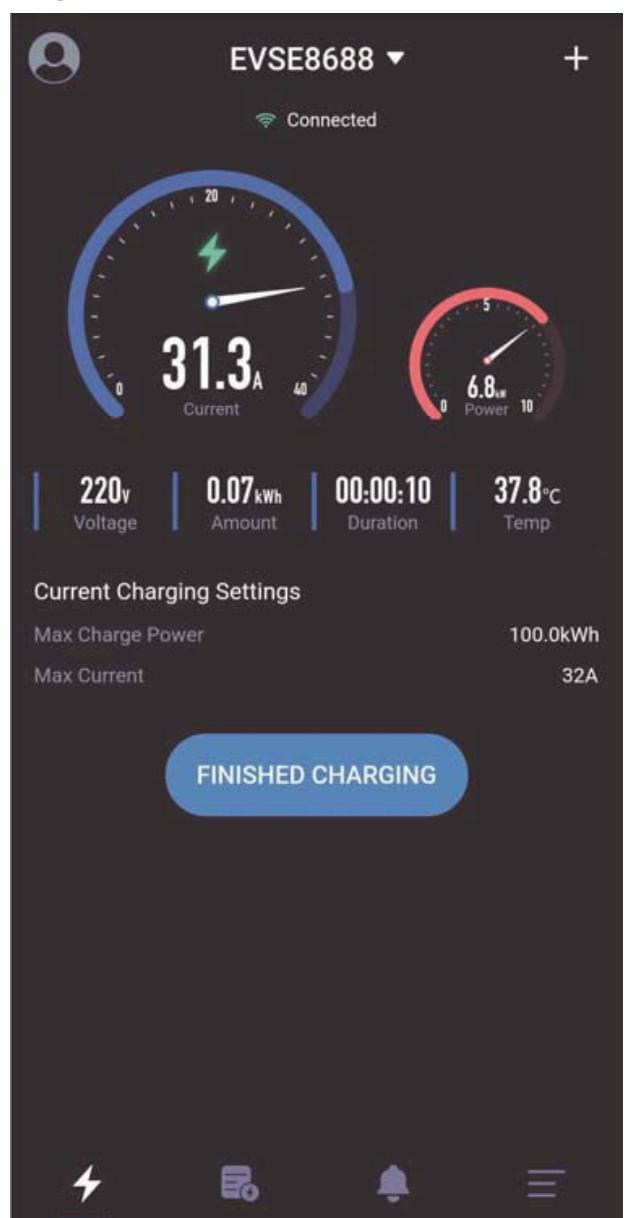
Imagen 18: Ventana de ajuste de los valores de la carga
