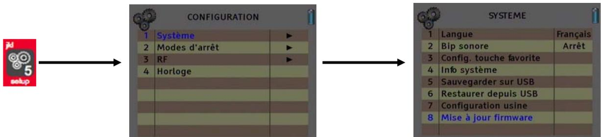
3. Connectez alors votre clé USB 2.0 au mesureur. Si la clé est correctement insérée et détectée par le mesureur, l'écran suivant s'affiche:
