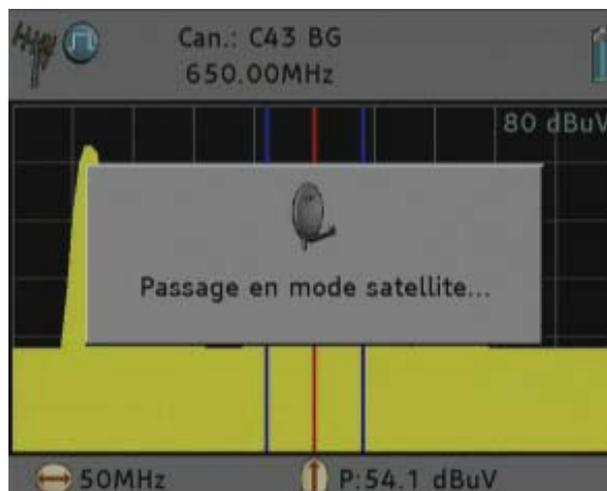
Une fois que vous êtes dans la bande satellite, le dessin d'une parabole apparaît en haut à gauche de l'écran, dans la barre d'état.
