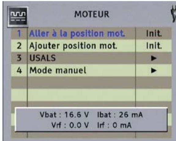
La première option du menu permet le positionnement de l'antenne sur n'importe laquelle des positions pré-définies dans la mémoire du moteur. Lors du choix de cette option, la commande DiSEqC correspondante est envoyée au moteur.
