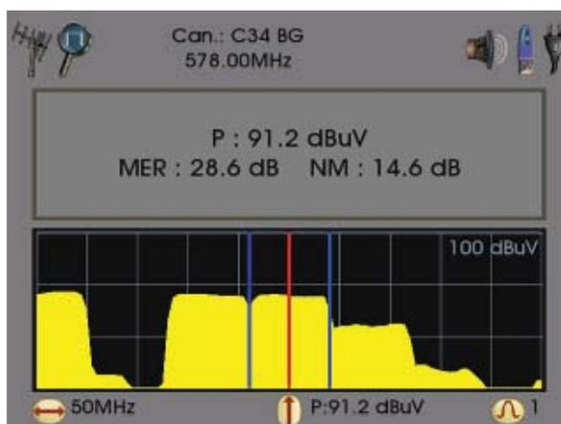
4.- **“tv”, “spectrum” et “meter”**. C'est le mode affichant le plus d'informations à l'écran. Vous pouvez voir simultanément la barre d'état, le spectre, l'image du canal (en mode numérique) et les valeurs des mesures effectuées sur le signal. Attention: L'image n'est pas affichée pour les signaux analogiques.
