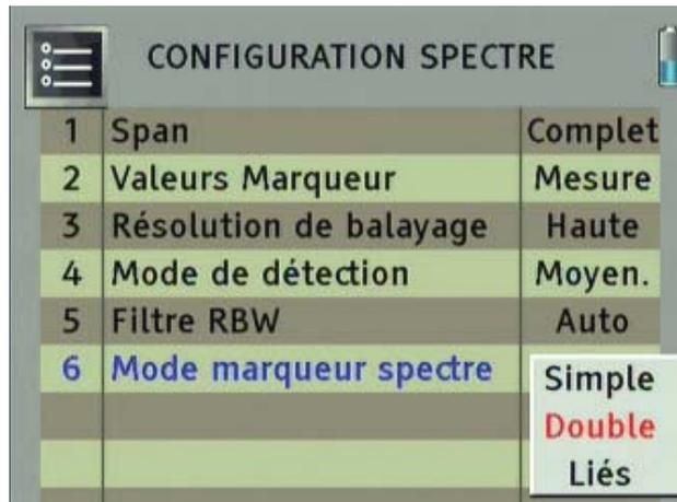
Dans le mode "Double", les déplacements des deux marqueurs sont contrôlés indépendamment. En mode "Liés" la distance en fréquence entre les marqueurs est fixe, et les marqueurs se déplacent de manière conjointe. Ceci peut s'avérer utile, par exemple, pour le réglage de filtres à une largeur spécifique.
