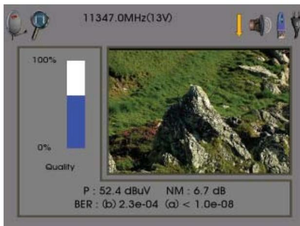
**3.- "spectre" et "mesures".** Avec ces deux options, l'écran est divisé en plusieurs parties horizontales affichants la barre d'état, les mesures du canal (différentes si le canal est analogique ou numérique), le spectre, le span, et le filtre de résolution utilisé.
