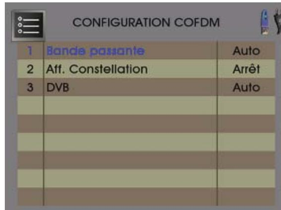
1) **Largeur de bande: auto, 8MHz, 7MHz et 6MHz**
