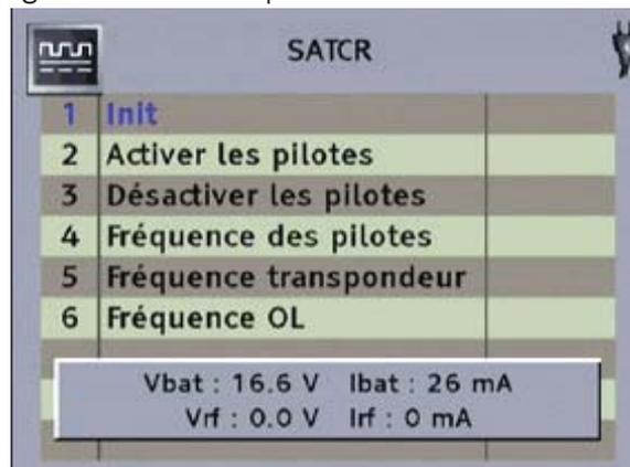
L'option "**Init**" force le démarrage du processus d'identification des prestations de la LNC.
