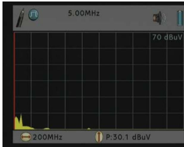
**3.- Touche “meter” active.** L'écran est divisé en deux parties: dans la partie supérieure est affichée la barre d'état, et dans l'autre partie sont affichées les mesures correspondant au signal sélectionné.
