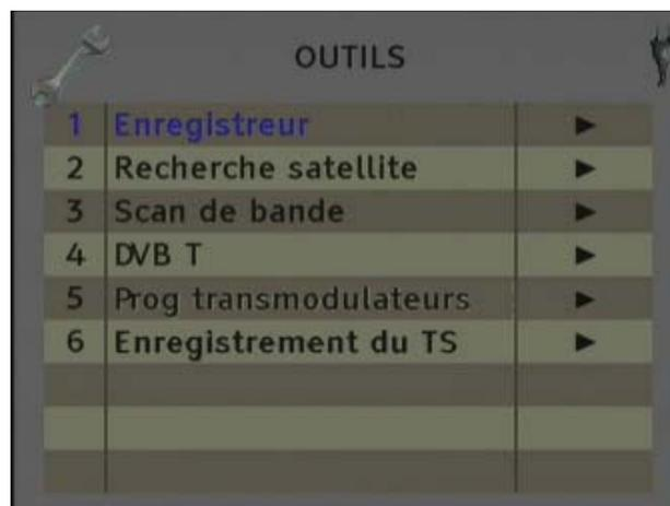
Le mesureur doit être en bande terrestre et câble pour pouvoir accéder à l'outil "Scan de Bande" (Touche 8 "Tools" -> "Scan de bande"). La fenêtre suivante s'affiche alors :
