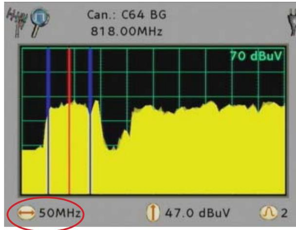
**3.- Touche "meter" active.** L'écran est divisé en deux parties: dans la partie supérieure est affichée la barre d'état, et dans l'autre partie sont affichées les mesures correspondant au signal sélectionné.
