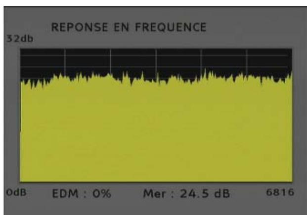
La réponse fréquentielle est pratiquement plane pour toutes les porteuses (6816 porteuses en mode 8K en DVB-T). Ceci signifie que toutes les porteuses disposent d'un très bon C/N. L'image suivante montre au contraire la réponse fréquentielle d'un signal avec un écho arrivant avec 2 µs de retard, l'écho ayant un niveau de puissance semblable à celui de la porteuse principale.
