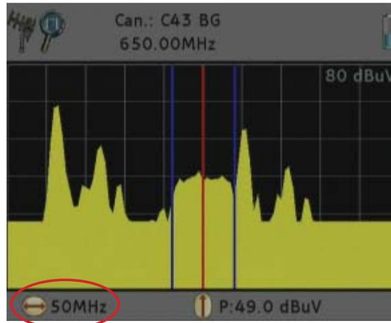
Une fois le spectre affiché et le span réglé, vous pouvez balayer la bande de fréquence à la recherche de votre signal grâce à la molette, en la tournant à droite ou à gauche.
