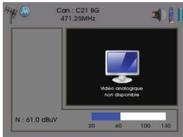
Pour les signaux numériques, l'écran est divisé en trois parties: barre d'état, image du premier programme des signaux FTA (non crypté), et une zone avec les mesures (puissance, marge de bruit, BER avant et après Viterbi, et barre graphique d'indication de qualité du signal).
