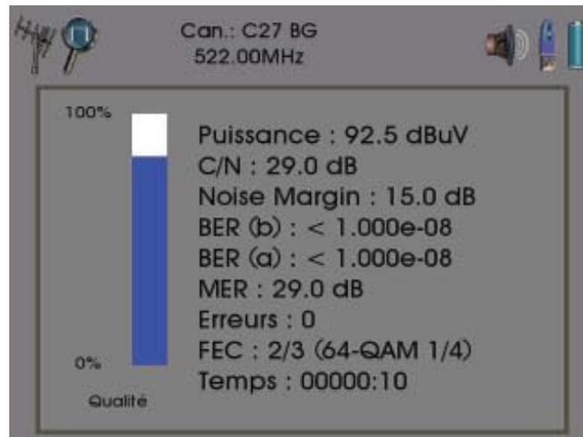
**Note:** Pour les signaux numériques la barre graphique de qualité est basée sur la mesure du Noise Margin. 0% correspondent au seuil minimal en dessous duquel le signal va pixeliser, 100% correspondent au Noise Margin maximal que peut afficher l'appareil.
