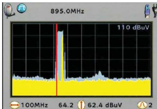
Vous verrez alors les porteuses en temps réel (en jaune) apparaître de temps à autre. L'enveloppe de ces signaux apparaît en gris, ce qui correspond au signal réel capturé par le mesureur.
