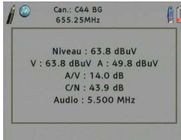
Si les LED des touches **"tv"** et **"spectrum"** sont allumées elles aussi, vous verrez alors à l'écran l'affichage simultané du spectre, de l'image et des mesures. Ces options ("**tv**" et **"spectrum"**) n'étant pas utiles pour l'instant, nous vous conseillons de les désactiver en appuyant sur les touches correspondantes pour faciliter la visualisation du spectre et la navigation. Le mesureur affiche alors les mesures suivantes:
