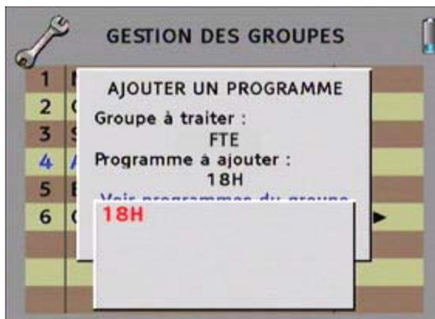
En appuyant sur **“Ajouter”**, le programme sera inclus dans le groupe choisi. La fenêtre d’ajout reste ouverte pour pouvoir ajouter d’autres programmes. Pour fermer la fenêtre, appuyez sur **“Fermer”**.
