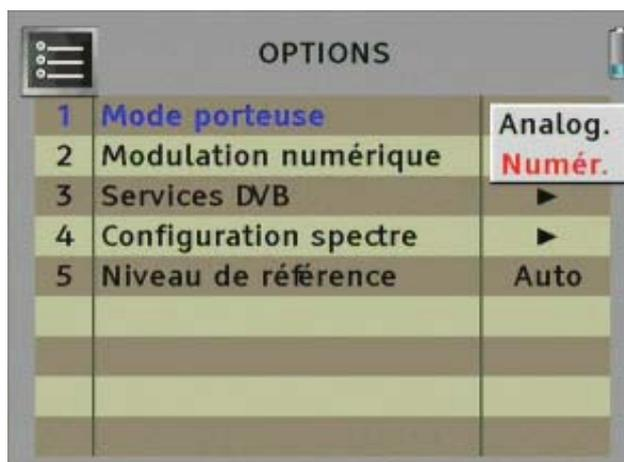
Choisissez l'option appropriée et confirmez en appuyant sur la molette (clic). En DVBC il n'est pas nécessaire de configurer les paramètres du signal. Sélectionner "Modulation digitale". Le mesureur détecte automatiquement les paramètres du signal.> Choisissez "Modulation numérique" dans les options. Vous devez alors régler les options suivantes:
