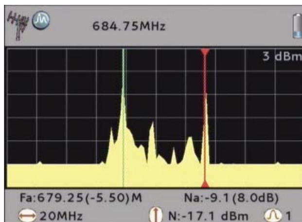
Sur cette image, le double marqueur est utilisé pour mesurer la séparation entre deux porteuses (vidéo et audio) et leur différence de niveau. Ici, le marqueur principal "Princ." se trouvant plus haut en fréquence que le marqueur auxiliaire "Aux" et sur un signal de moindre niveau, aussi bien les mesures de fréquence que les mesures de niveau affichent des valeurs négatives.
