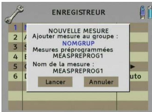
Un point de mesure préprogrammé est semblable à un point de mesure classique, sauf que vous n'avez pas besoin de le saisir dans le mesureur. Pour créer ces points de mesure préprogrammés, nous vous recommandons la version complète du logiciel enregistreur (datalogger) qui vous permettra de créer les groupes, les programmes et les mesures et de créer un rapport.
