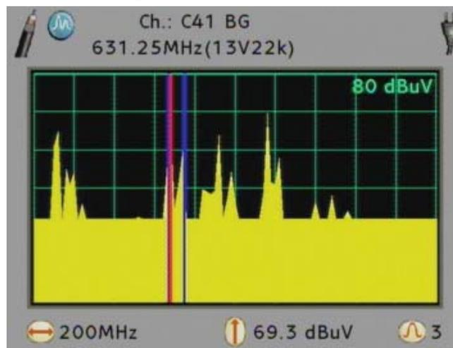
Une fois le spectre affiché et le span réglé, vous pouvez balayer la bande de fréquence à la recherche de votre signal grâce à la molette, en la tournant à droite ou à gauche.
