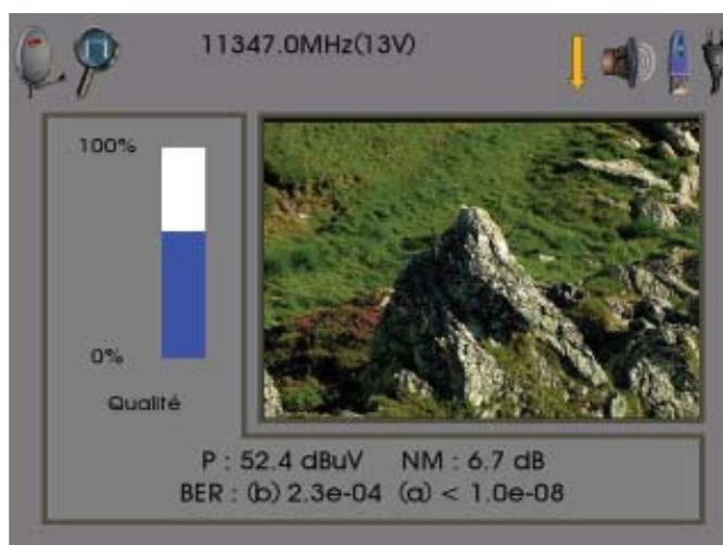
**4.- "tv", "spectrum" et "meter".** C'est le mode affichant le plus d'informations à l'écran. Vous pouvez voir simultanément la barre d'état, le spectre, l'image du canal (en mode numérique) et les valeurs des mesures effectuées sur le signal. Attention: en mode analogique, l'image de la chaîne n'est pas affichée.
