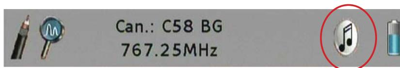
Si l'option Buzzer est sélectionnée, le signal audio du canal est remplacé par le sifflement.
