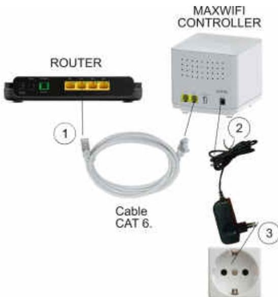
1) Connectez un côté du câble LAN cat 6 U/UTP dans un port LAN du routeur de votre opérateur et l'autre côté au port WAN du périphérique MAXWIFI marqué comme « Controller ».
