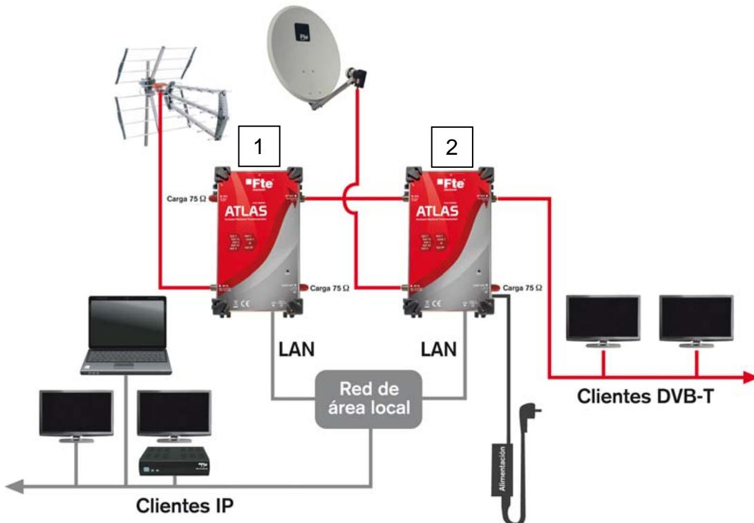
\* Las cargas de  $75\ \Omega$  son aisladas. Si necesita cargas adicionales aisladas puede usar la referencia FCF (cod. 0605590).
