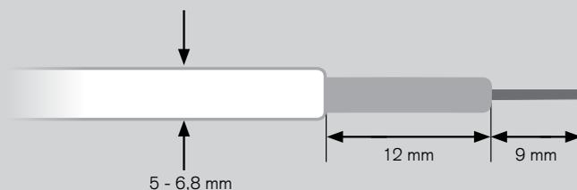
Structure de coupe de câble coaxial pour le montage
