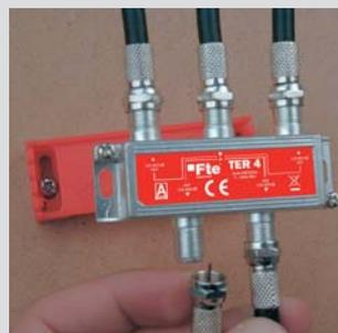
3. Fixer l'élément passif à la base en faisant pression.
